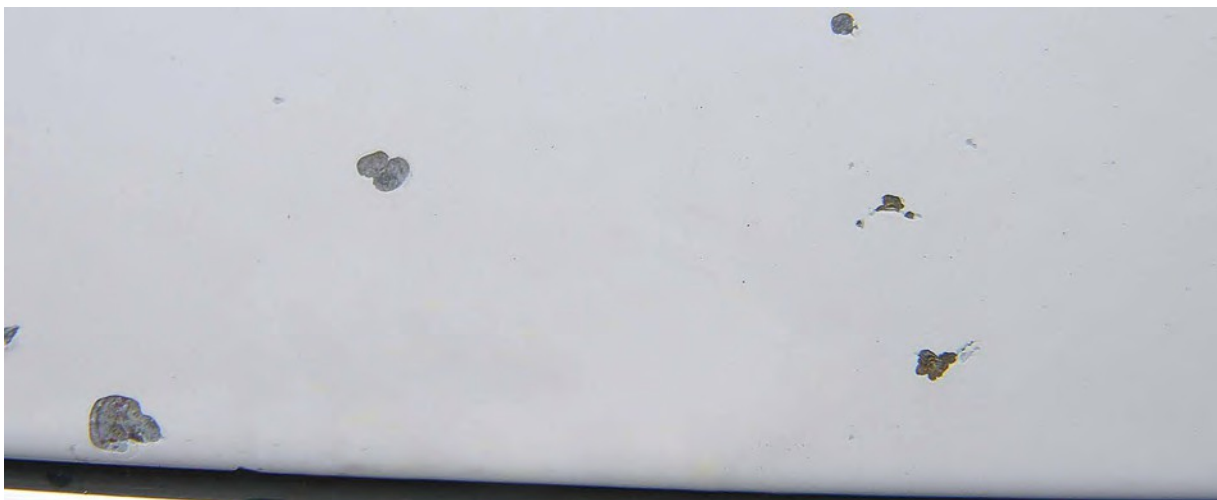
Više oštećenja od kamenčića na površini 10 x 10 cm
