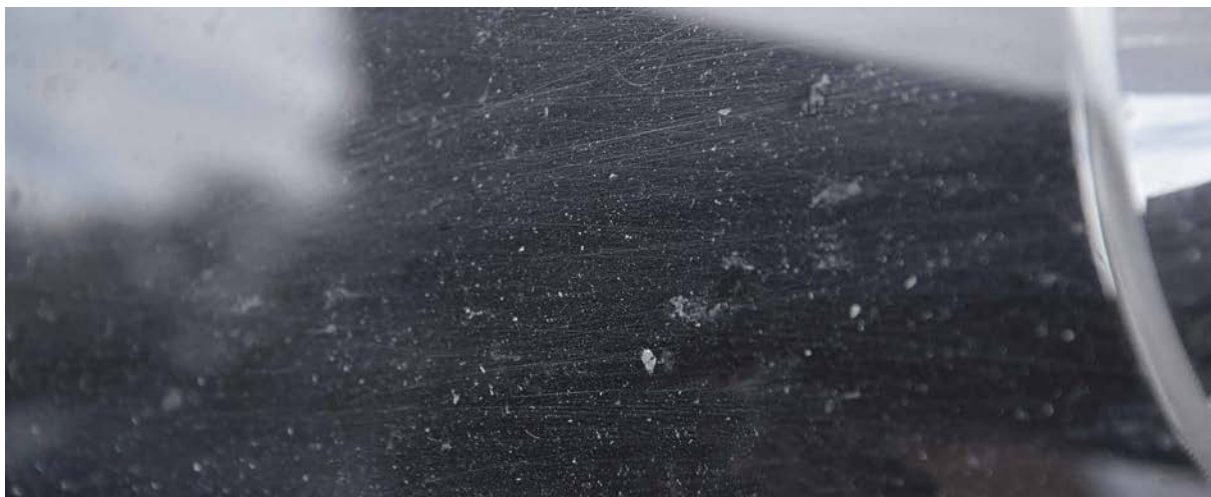
Malo oštećenje od kamenčića
