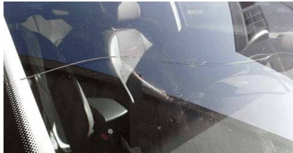
Pukotina na vjetrobranskom staklu
