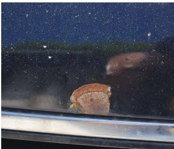
Velika oštećenja od kamenčića sa znakovima hrđe
