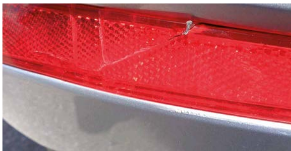
Polomljeni manji dijelovi stakla
