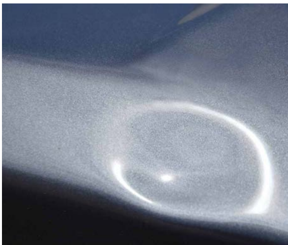
Veliko udubljenje prečnika veće od 2 cm
