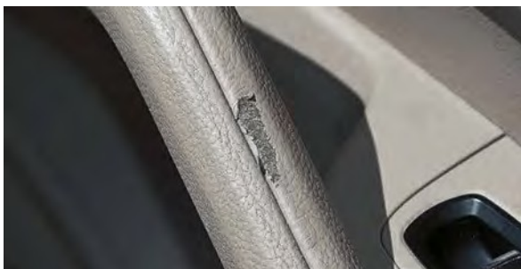
Oštećena obloga vrata
