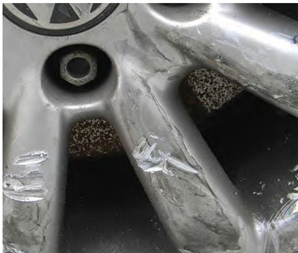
Aluminijska felga znatno oštećena
