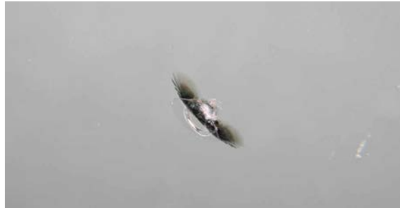
Pukotina u obliku krila pčele na vjetrobranskom staklu
