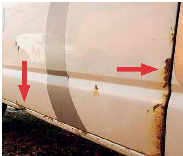
Vozilo sa znakovima korozije
