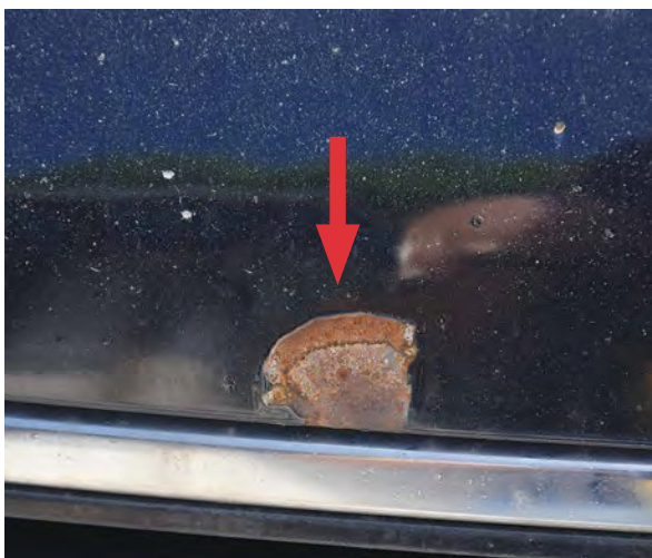
Veliko oštećenje od kamenčića sa korozijom
