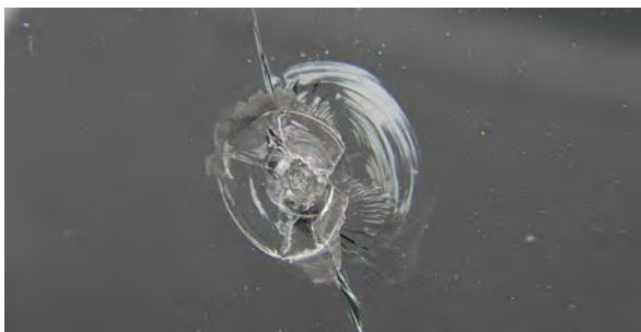
Pukotina na vjetrobranskom staklu
