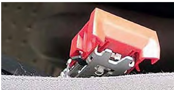
Oštećen završetak sigurnosnog pojasa
