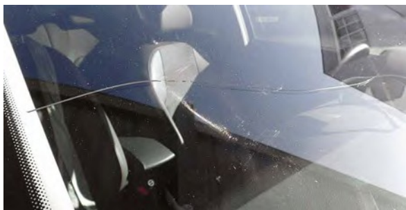
Pukotina na vjetrobranskom staklu
