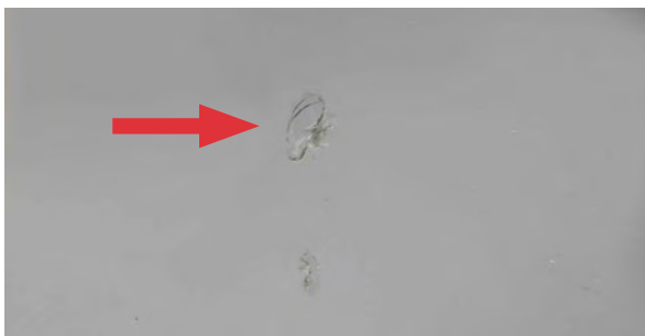
Loše sanirano oštećenje od kamenčića na vjetrobranskom staklu
