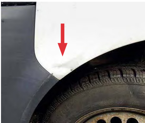
Jako oštećen blatobran
