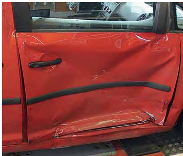
Veća oštećenja na području vrata
